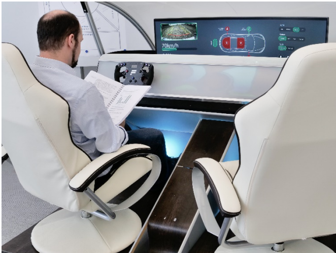
Abb. 1 Im Mobility Innovation Lab am Fraunhofer IAO demonstriert ein futuristisches Fahrzeugcockpit mit modularem Armaturenbrett, schaltbaren Scheiben, Sitzen mit Relax-Position, ausklappbaren Tischen und ausfahrbarem Monitor das Innenraum-Erlebnis der Zukunft.
